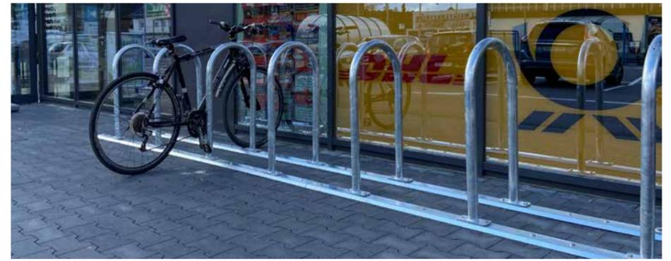
**Anlehnbügel** aus Stahlrohr Ø 48 mm,
