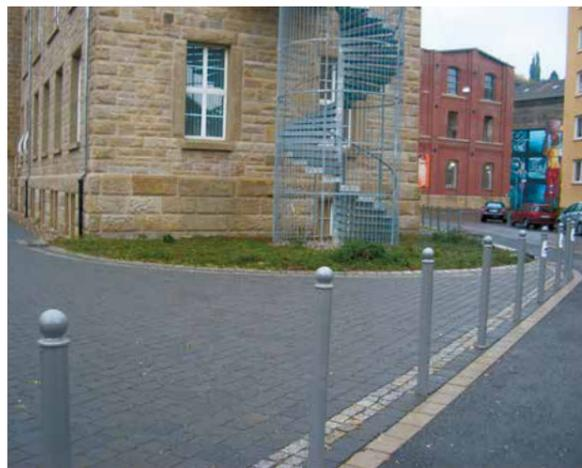
**Stilpoller** aus Stahlrohr, Ø 82 mm, ca. 900 mm Überflur, feuerverzinkt und beschichtet
